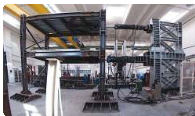
Test pseudodinamico su struttura in scala reale
